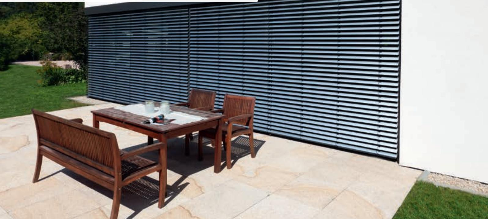
Fenster-System-Raffstoren lassen sich unauffällig oder als sichtbares Element in die Fassade integrieren. Da sich die Anlagen nahtlos in Wärmedämmverbundsysteme einfügen, erfüllen diese Raffstoren problemlos die kontinuierlich weiter steigenden Wärmeschutzanforderungen. Die Raffstoren können mit Schienen- oder Seilführung ausgeführt werden. Unsere Seil-/ Schienenkombination ist die perfekte Lösung für Ganzglasecken.
